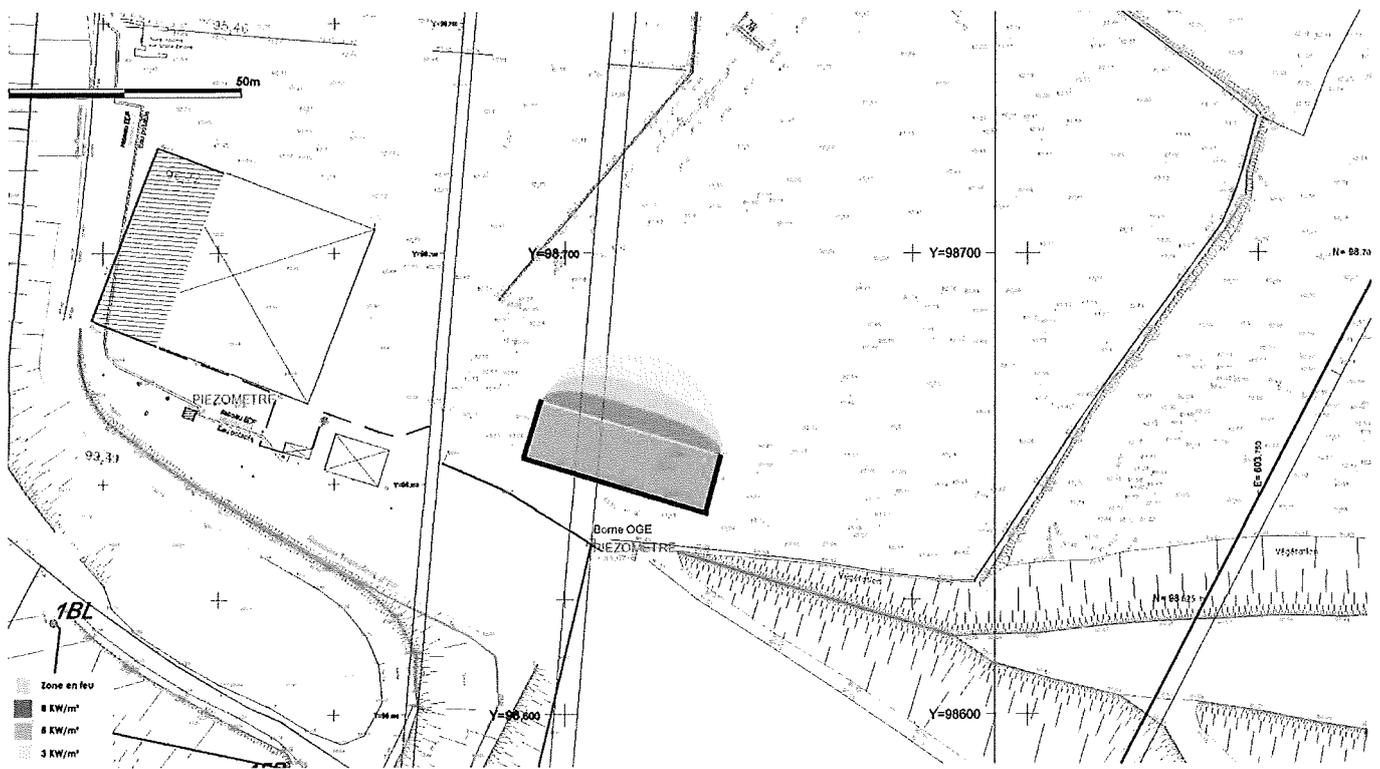
Figure 2 : Localisation du stockage avec mur coupe feu hauteur 4m autour du stock -- CAS 2
