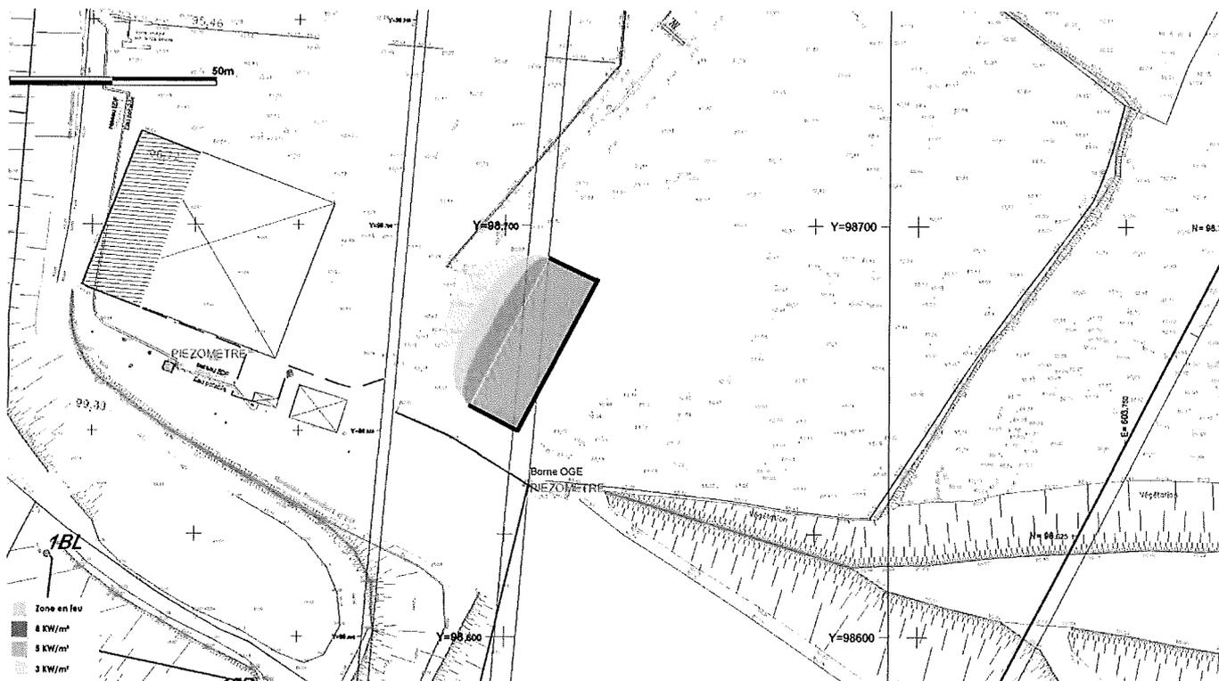
Figure 1 : Localisation du stockage avec mur coupe feu hauteur 4m autour du stock -- CAS 1
